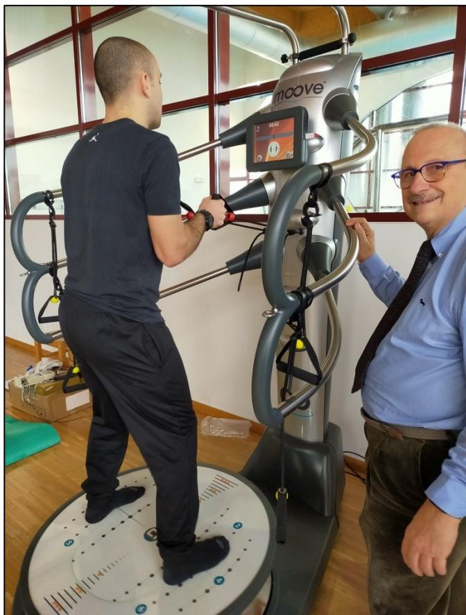
Il test consiste in una prova della durata di 1 minuto, durante la quale agli atleti è stato chiesto di mantenere l'equilibrio sulla pedana d'appoggio podalico mentre questa si muoveva con un movimento ellissosferico, e nel mentre esercitare una tensione costante a livello degli elastici messi in tensione dagli arti superiori;
